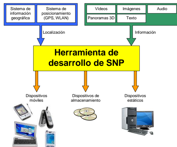
Imagen 9. Diagrama de entradas y salidas de la herramienta de desarrollo de Sistemas de Navegación Pedestre
